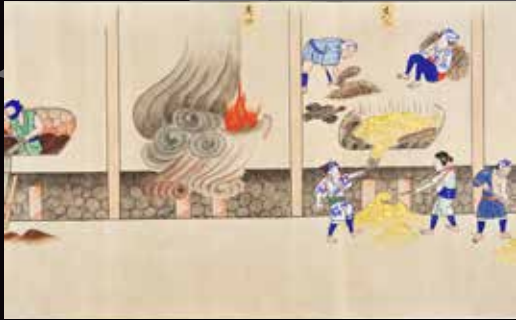
3 選別した黄銅鉱を30日間焼いて硫黄を除去(焼鉱の製造)
