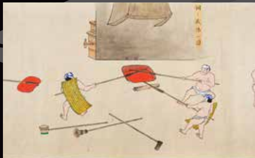
5 炉の床に溜まった粗銅(鉞)を掻き揚げる
