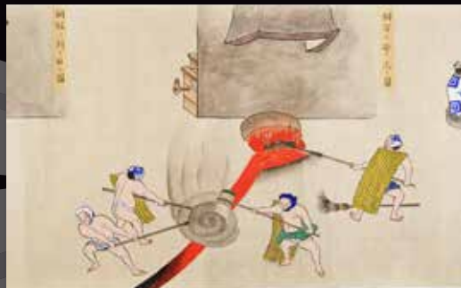
4 焼鉱を木炭とともに加熱溶解してカラミ(鉱滓)を掻き出す
