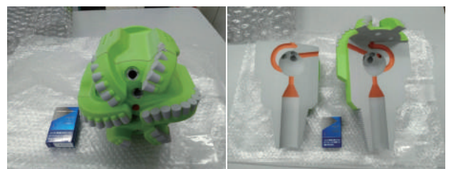
図6 熱衝撃破壊掘削ビットの構造模型
