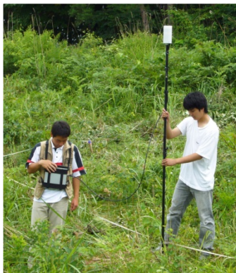
手形山でプロトン磁力計を用いて磁気探査を行う学生実験の様子
