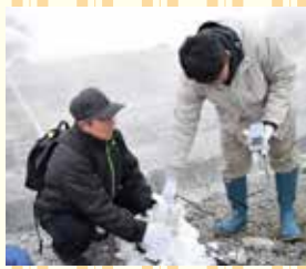
敷地内の川の水をPH測定器で測定したところ、PH1.45を示しました
