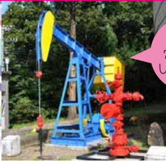
ポンピングユニットと圧力調整弁
